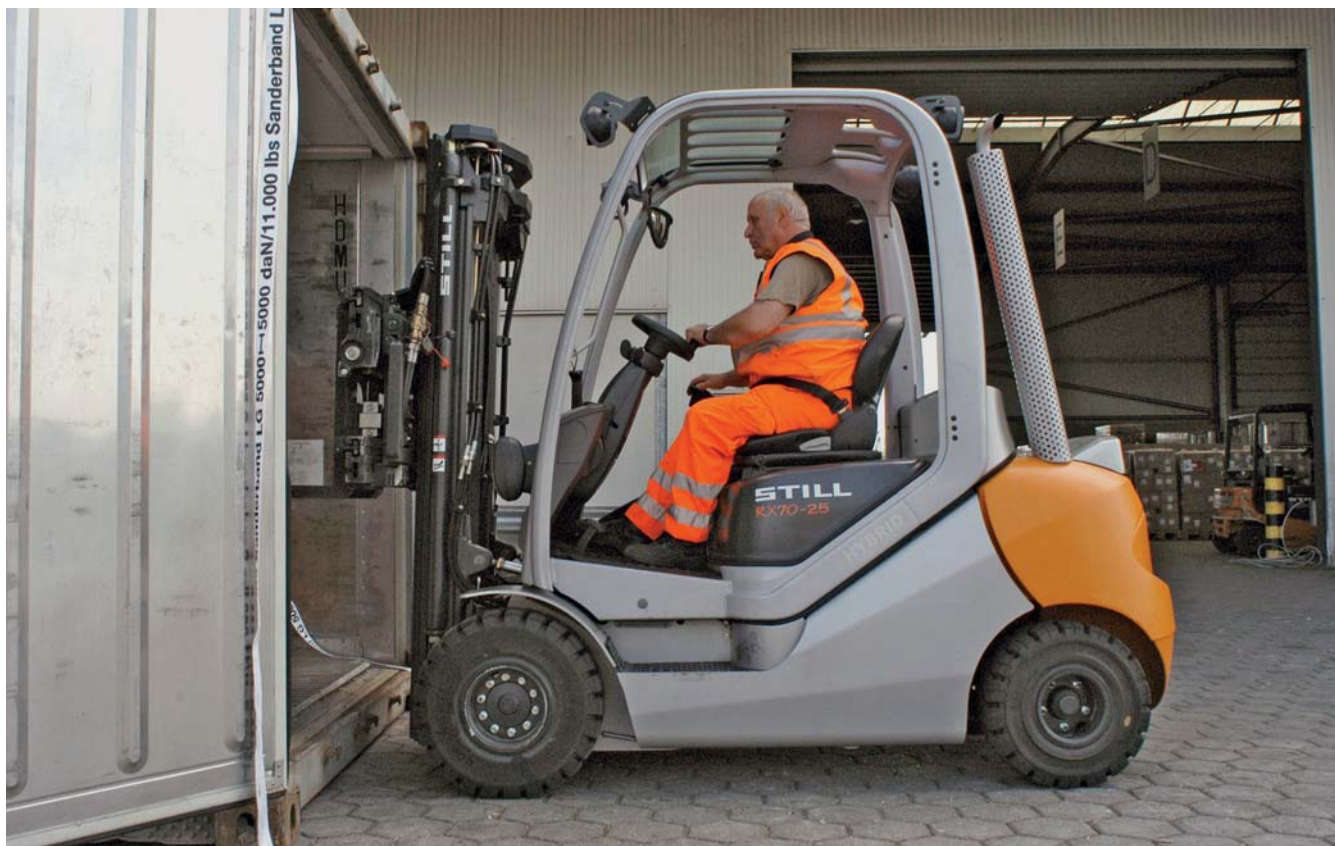
Figur 3: På nogle trucks er førerkabinen elastisk ophængt, hvilket reducerer vibrationsbelastningen.
